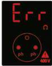
400 V altındaki fazlar arası bağlantı
