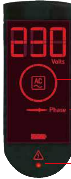
KIRMIZI renkte görüntülenen 230 V AC algılama örneği.
