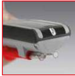
Ölçüm noktasını aydınlatan aydınlatma lambası
